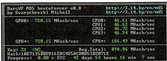
Schon eine einzelne Nvidia-GPU vom Typ GTX 280 erreicht fast die Performance des 24-Kerners. BarsWF listet unter dem Durchschnitt der Einzelkomponenten auch die Gesamtgeschwindigkeit.
